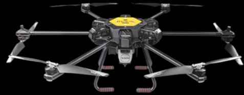
搭载南方SF1650六旋翼续航50min
