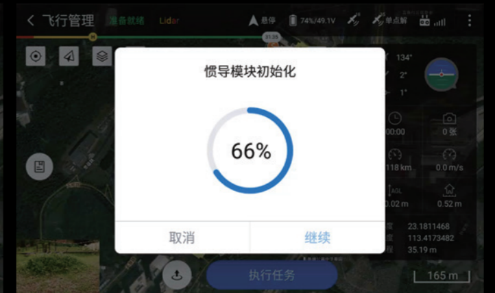
c. 起飞前自动进行激光自检和惯导初始化(无须飞八字)。
