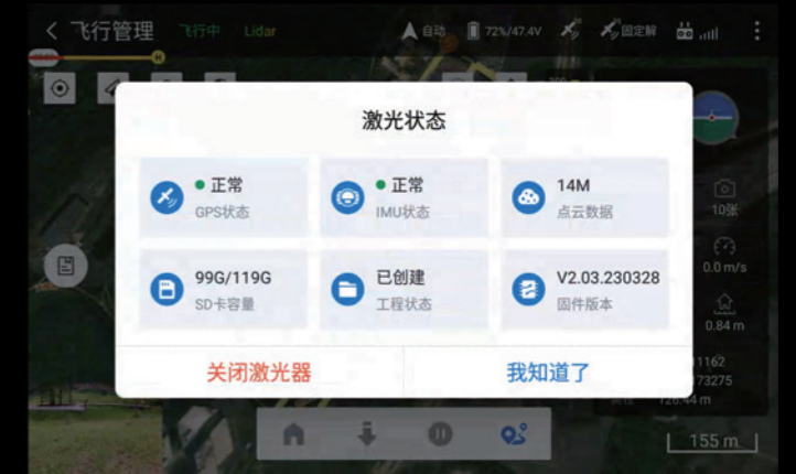
b. 飞机遥控器实时查看激光状态，自动化控制激光雷达和POS启停。
