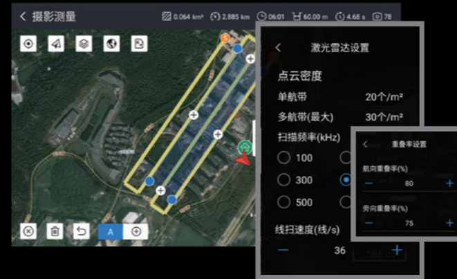
a. 可以通过飞机遥控器直接设置雷达参数。
